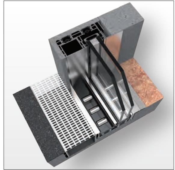
Zu den Merkmalen des Schiebeseystems gehört eine Lösung für den Wasserablauf, die in den Boden eingelassen werden kann.
