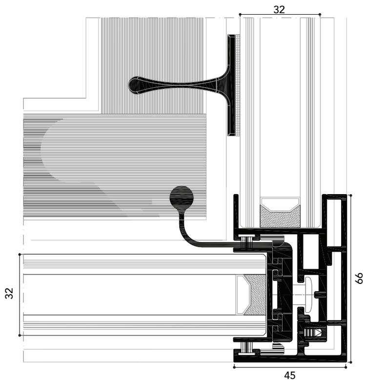
Die Lösung mit offener Ecke ermöglicht die vollständige Öffnung von zwei beweglichen Flügeln in der Ecke, ohne dass ein Pfostenprofil erforderlich ist.
