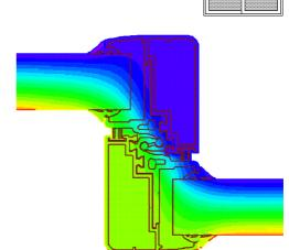
Cam Kalınlıkları (GLASS THICKNESS): 20 / 22 / 24 mm
